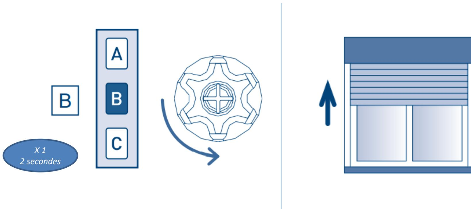
➡ Le volet roulant effectue un **mouvement de montée**.
